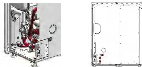
Raccords hydrauliques arrière, accessibles par le côté droit. Nouvelle position, facilement accessible pour les raccordements et les interventions.
